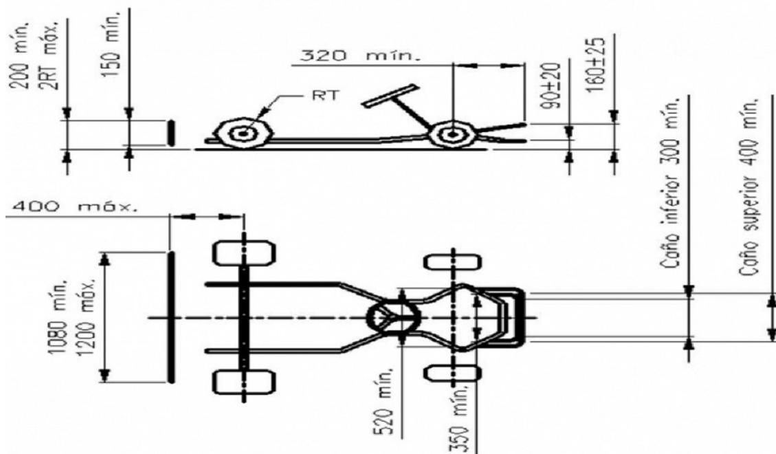
Protección de las ruedas traseras: obligatorio Altura mínima superior de 150mm del suelo. Ancho mínimo: 1080mm. Ancho máximo: 1200mm.
